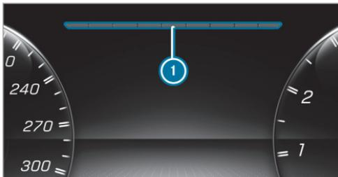
Si el número de revoluciones del motor es demasiado alto o bajo, no podrá cambiar de marcha con las levas de cambio del volante. En tal caso, los segmentos ① se iluminan en color rojo.
