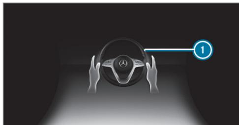
Si el sistema detecta que el conductor no gira el volante o que retira las manos del volante durante cierto tiempo, se muestra la indicación ❶ en el visualizador del cuadro de instrumentos. Si el conductor sigue sin realizar maniobras de forma activa o no responde al sistema, adicionalmente a la advertencia óptica se emite repetidamente una señal acústica de advertencia.
