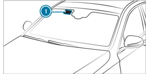
Los aparatos accionados por radio como, por ejemplo, los sistemas de peaje, solo pueden montarse en la superficie permeable a las ondas radioeléctricas ① del parabrisas.
