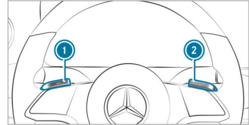
Si el cambio automático está acoplado en la posición **D**, puede cambiar de forma manual con las levas de cambio en el volante. Siempre y cuando esté permitido, el cambio automático acopla una marcha superior o inferior, según la leva de cambio en el volante accionada.
