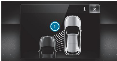
Si se produce una intervención en el freno para corregir la dirección, parpadea el testigo luminoso de advertencia rojo del retrovisor exterior y suena una señal acústica de advertencia. Adicionalmente se muestra una indicación ① en el visualizador del cuadro de instrumentos que indica el peligro de colisión lateral.
