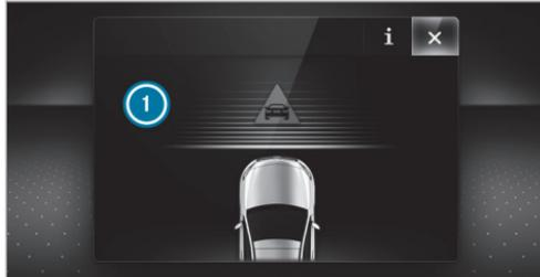
Si se ha realizado un frenado autónomo o se ha activado la servoasistencia de frenado en función de la situación, en el visualizador del cuadro de instrumentos se muestra la indicación ⓘ que desaparece automáticamente poco después.
