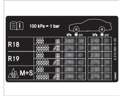
Algunas tablas de presiones de neumáticos muestran solo diámetros de llanta en lugar del tamaño de neumático completo, por ejemplo, **R18**. El diámetro de la llanta forma parte del tamaño del neumático y está inscrito en el flanco del neumático (→ página 356).
