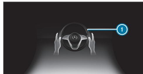
Si el sistema detecta que el conductor no gira el volante o que retira las manos del volante durante cierto tiempo, se emite la indicación ①. Si el conductor sigue sin mover el volante de forma activa, además de la advertencia óptica suena una señal acústica de advertencia.
